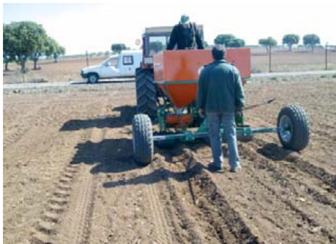
Izquierda: Abonadora de aplicación localizada de doble tolva utilizada para la aplicación del compost. Dcha: Detalle de la aplicación del compost en surco y posterior enterrado.
