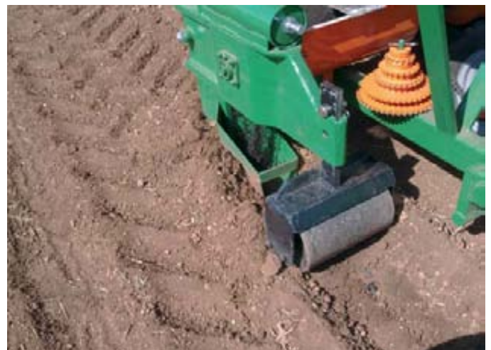
Izquierda: Abonadora de aplicación localizada de doble tolva utilizada para la aplicación del compost. Dcha: Detalle de la aplicación del compost en surco y posterior enterrado.
